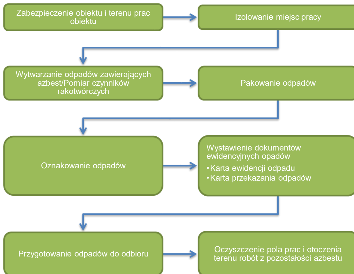
Rysunek 7. Schemat procedury dotyczącej prac polegających na usuwaniu wyrobów zawierających azbest, wytwarzania odpadów niebezpiecznych wraz z oczyszczaniem obiektu/terenu/instalacji.
